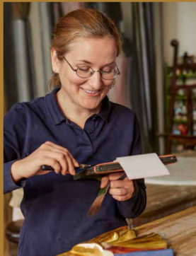
Volle Konzentration: Mit einem Messer bringt Michelle das Blattgold auf dem Lederkissen in Position und in die richtige Größe (l. o.). Beim sogenannten Anschließen wird das Blattgold per Pinsel auf die Oberfläche aufgelegt (s. o.). Jeder Handgriff muss dabei sitzen, denn gefaltet oder geknüllt wird Blattgold unbrauchbar (l. u.). Bild u. r.: Musterplatten mit verschiedenen Veredelungstechniken
