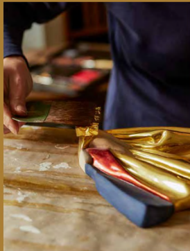
Volle Konzentration: Mit einem Messer bringt Michelle das Blattgold auf dem Lederkissen in Position und in die richtige Größe (l. o.). Beim sogenannten Anschließen wird das Blattgold per Pinsel auf die Oberfläche aufgelegt (s. o.). Jeder Handgriff muss dabei sitzen, denn gefaltet oder geknüllt wird Blattgold unbrauchbar (l. u.). Bild u. r.: Musterplatten mit verschiedenen Veredelungstechniken
