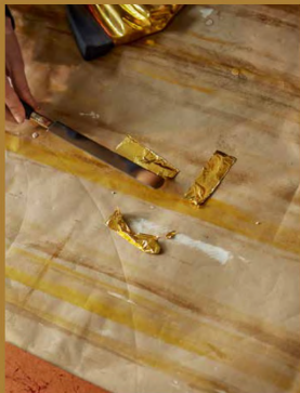
Volle Konzentration: Mit einem Messer bringt Michelle das Blattgold auf dem Lederkissen in Position und in die richtige Größe (l. o.). Beim sogenannten Anschließen wird das Blattgold per Pinsel auf die Oberfläche aufgelegt (s. o.). Jeder Handgriff muss dabei sitzen, denn gefaltet oder geknüllt wird Blattgold unbrauchbar (l. u.). Bild u. r.: Musterplatten mit verschiedenen Veredelungstechniken
