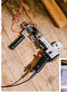
Schwergewicht: Eine Tufting-Pistole wiegt knapp zwei Kilo. Sie funktioniert nach dem Prinzip einer Nähmaschine. Garn dafür ist reichlich vorhanden – vor allem in Lilä, Zeyus Lieblingsfarbe
